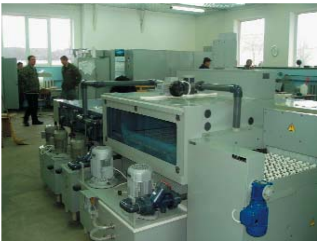
Рис. 1. Линия щелочного травления ПП
