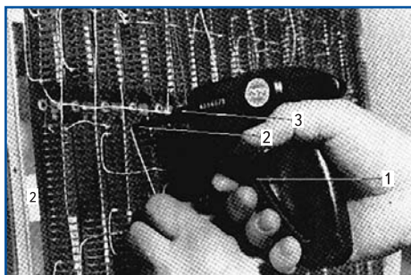
Рис. 5. Инструмент для накрутки в руках оператора:
