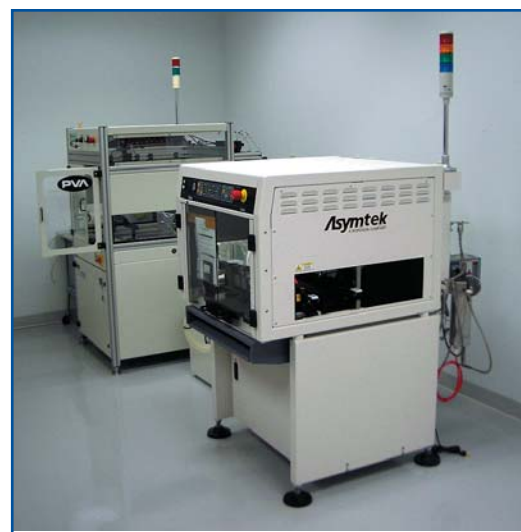
Рис. 2. Машина для селективной влагозащиты Asymtek
