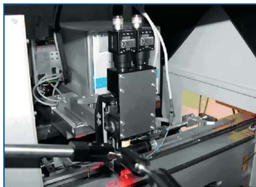
Рис. 1. Пример оптической инспекции качества посадки кристалла. Конфигурация системы РВИ с двумя камерами различной степени разрешения
