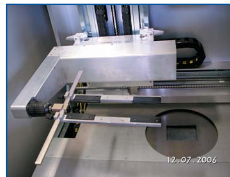
Рис. 23. Моторизованная система вращения печатной платы в системе рентгеновского контроля Х8011
