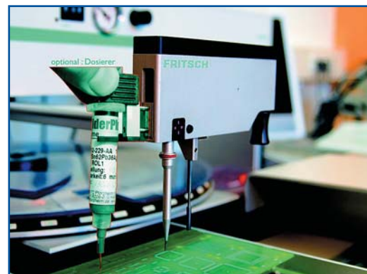
Рис. 2. Установочная головка (слева направо) с дозатором (опция), вакуумным пинцетом и направляющим штырем
