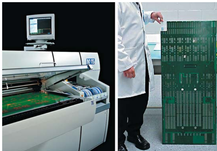
Рис. 13. Пример установки стола для сборки крупных плат
