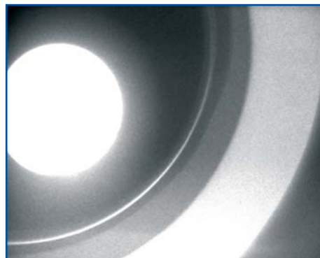
Рис. 46. Рентгеновский снимок сварного шва, сделанный на системе X-8011 при интеграции изображения = 32 (макс. для данной системы)
