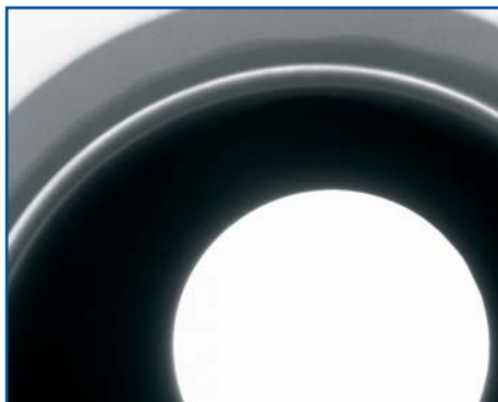
Рис. 45. Рентгеновский снимок сварного шва, сделанный на системе microme | x при интеграции изображения 64
