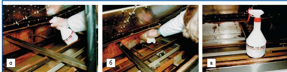
Рис. 1. а) Нанесение VIGON RC101; б) протирка; в) сушка
