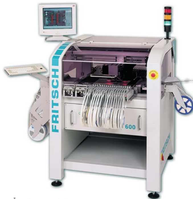
Рис. 4. Уникальный автомат установки компонентов для многономенклатурных мелкосерийных производств PlaceALL600
