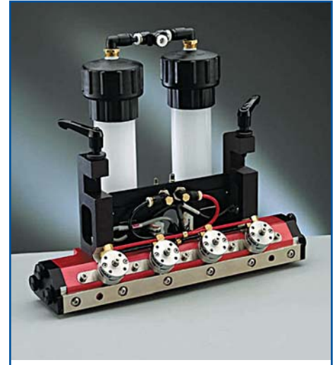
Рис. 9. Голова принтера с реометрической помпой
