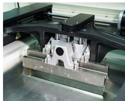
Рис. 3. Голова принтера с самовыравнивающимися ракетами
