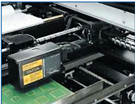
Рис. 5. Система выравнивания трафарета Vision On-the-Move
