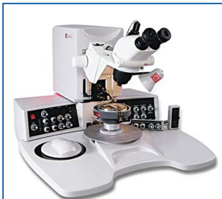
Рис. 2. Ручная аналоговая установка клиновой микросварки 4526 с функцией автовозврата
