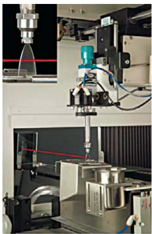
Рис. 4. Контроль ширины струи с помощью лазерного луча
