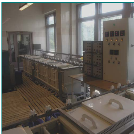
Рис. 1. Линия прямой металлизации и линия гальванического осаждения меди и металлорезиста
