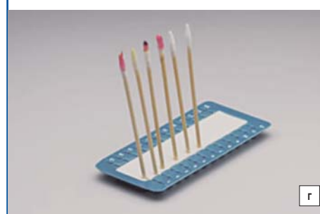
Рис. 8. Косвенный метод тестирования (нет прямого контакта тестируемой поверхности с химическими реактивами):
