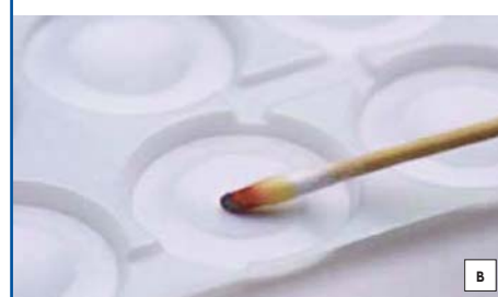
Рис. 6. Прямой тест печатного узла на наличие свинца проводится с помощью карандаша-тестера LeadCheck®:
