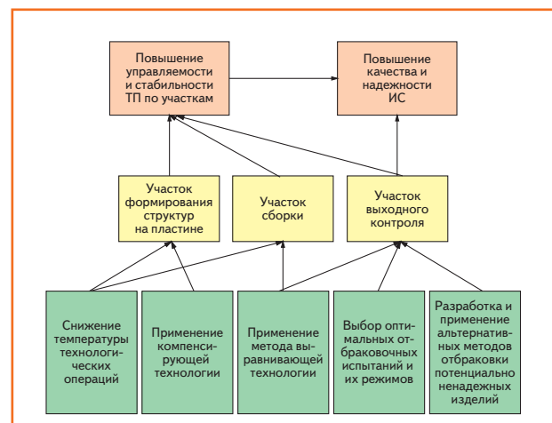
Рис. 2. Схема реализации технологических методов повышения надежности ИС в процессе серийного производства
