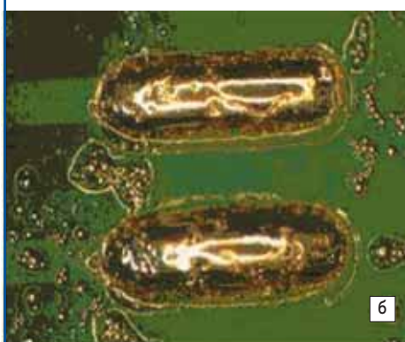
Рис. 5. Результат визуального контроля при отмычке трафарета с использованием изопропилового спирта
