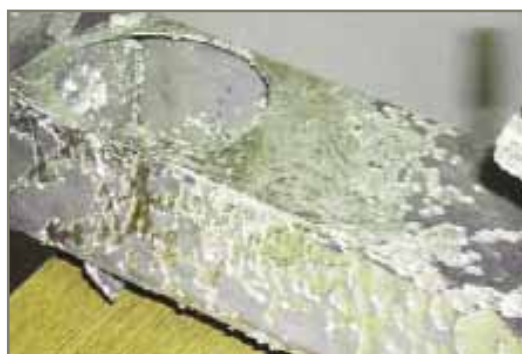
Рис. 1. Повреждение канала подачи припоя из нержавеющей стали
