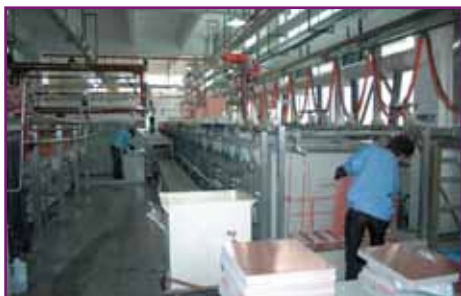
Рис. 2. Химико-гальваническая линия с производительностью 24 м 2 /ч
