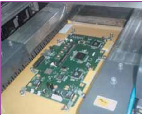
Рис. 12. На пайку волной платы поступают в оснастке, предотвращающей коробление и ограничивающей зоны контактирования припоя с поверхностью платы
