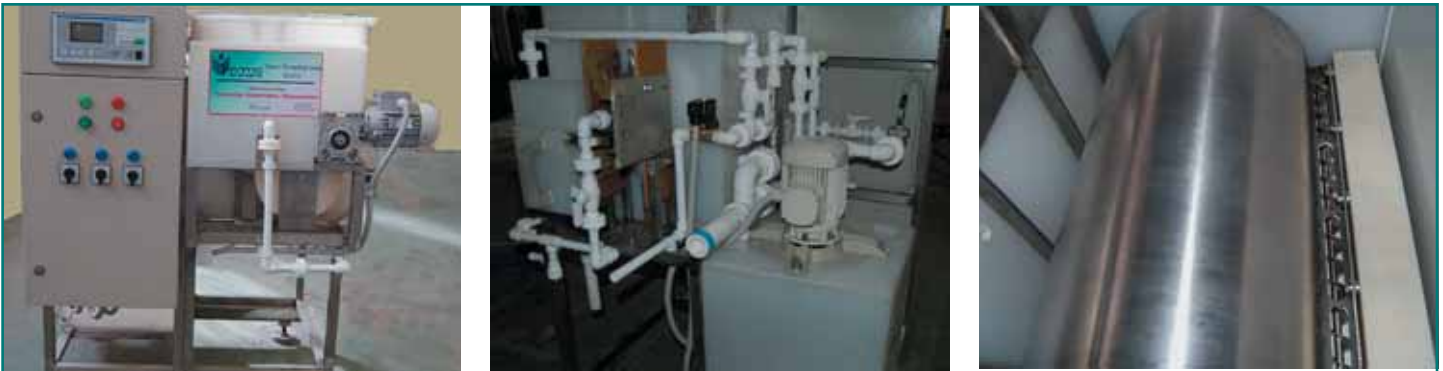
Рис. 9. Установка регенерация раствора травления печатных плат
