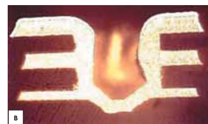
Рис. 2. Микроотверстия, сформированные различными методами (для всех методов — отношение «глубина/диаметр» \leq 1:1 ): а) ультрафиолетовый лазер, луч 25 мкм, спиральный путь луча; б) лазер CO 2 , луч 350 мкм, выжигание через трафарет; в) сверловка (механическая) с контролем глубины сверления
