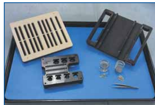
Рис. 2. Обычные инструменты и оснастка для установки заготовок припоя
