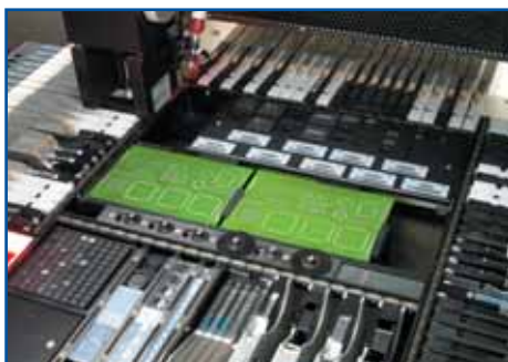
Рис. 3. Универсальная магнитная система фиксации ПП
