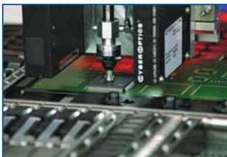
Рис. 2. Лазерная система центрирования Cyberoptics™
