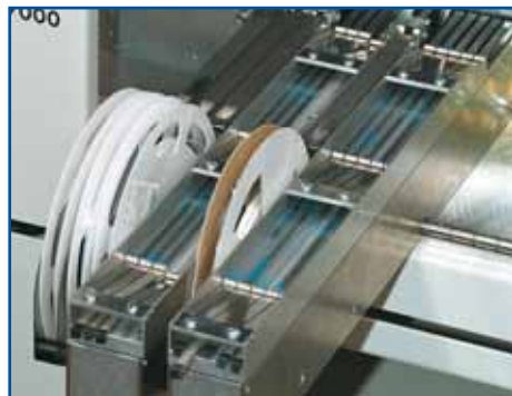
Рис. 5. Ленточные питатели, пенальный вибропитатель, питатель для отрезков лент
