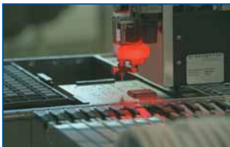
Рис. 4. Верхняя CCD-камера со светодиодной подсветкой
