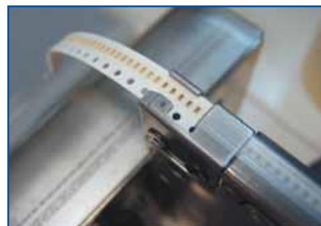
Рис. 7. Реперный знак на питателе и перфорация ленты — используются при корректировке места забора компонента
