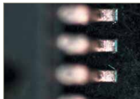
Рис. 8. Оловянный «ус» на контакте компонента QFP
