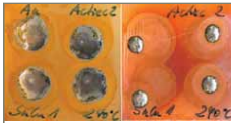
Рис. 1. Оплавленные шарики припоя SnCu1 на поверхности NiP/Au (слева) и на поверхности Cu/OSP (справа)
