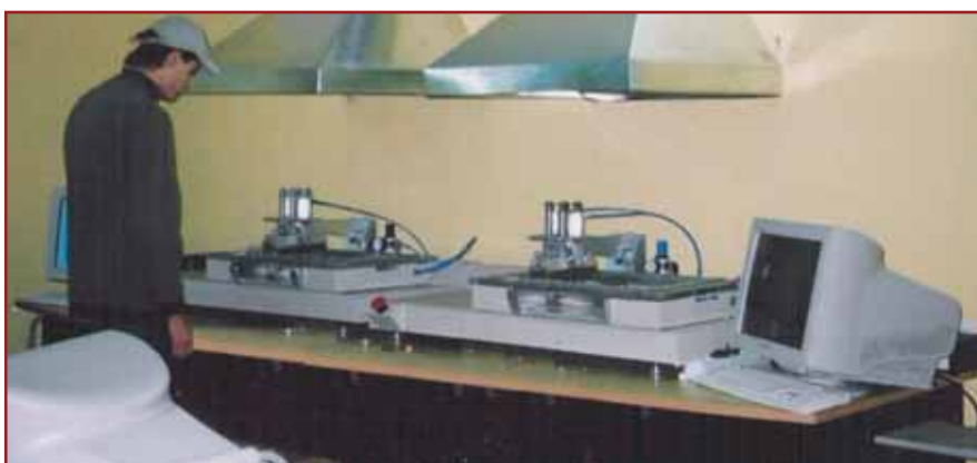
Рис. 1. Участок трафаретной печати с двумя полуавтоматами M2031
