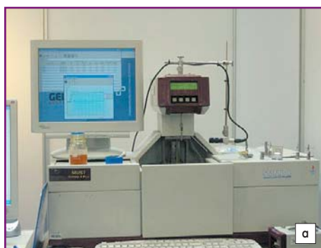
Рис. 4. а) Установка для тестирования паяемости MUST III;
