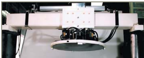
Рис. 5. Устройство для электростатической левитации кремниевых пластин
