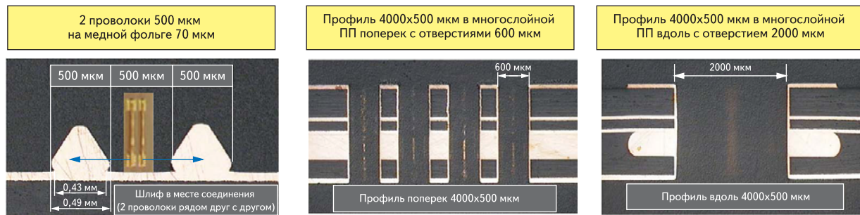
Рис. 3. Примеры ультразвуковой технологии соединения
