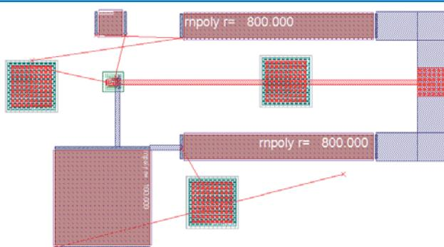
Рис. 11. Топология межслойного перехода на ранней стадии проектирования кристалла
