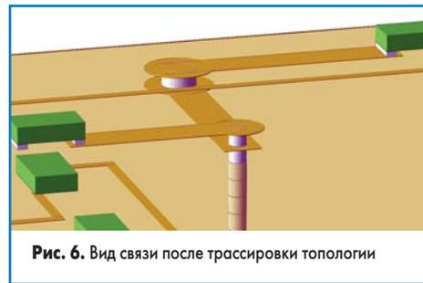
Рис. 6. Вид связи после трассировки топологии
