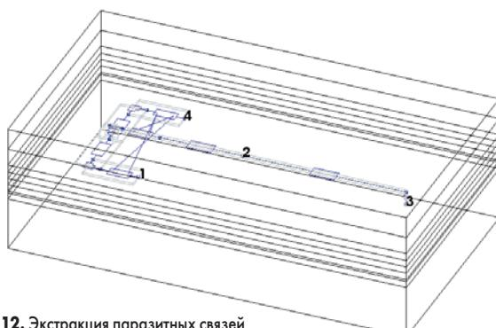
Рис. 12. Экстракция паразитных связей межслойного перехода с помощью технологии ACE
