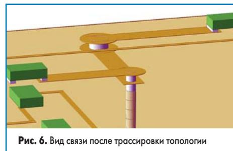
Рис. 6. Вид связи после трассировки топологии
