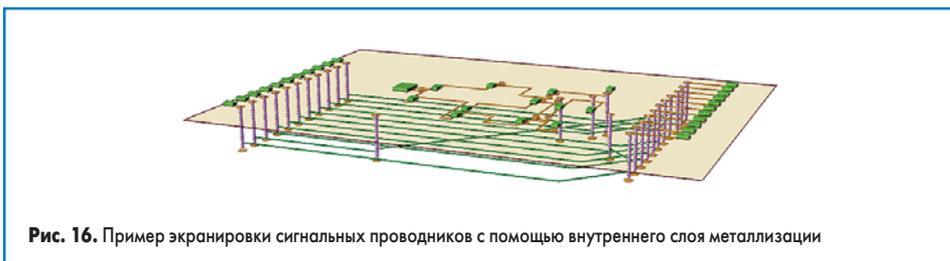
Рис. 16. Пример экранировки сигнальных проводников с помощью внутреннего слоя металлизации
