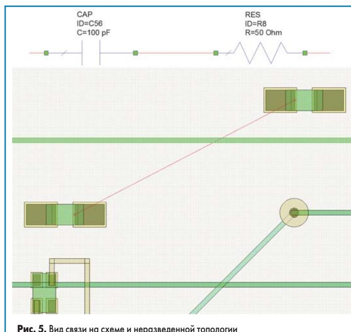
Рис. 5. Вид связи на схеме и неразведенной топологии
