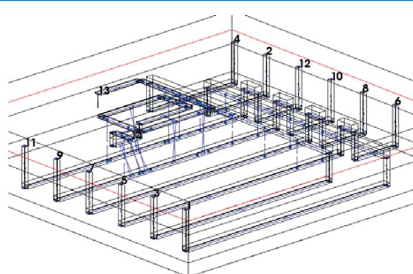
Рис. 14. Паразитные связи катушки индуктивности с линиями управления
