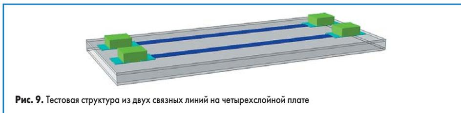
Рис. 9. Тестовая структура из двух связанных линий на четырехслойной плате
