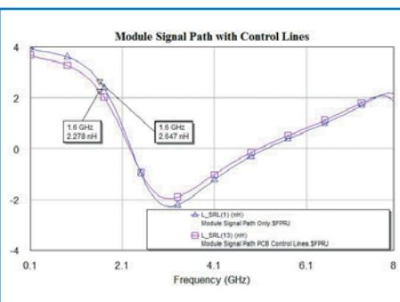
Рис. 15. Влияние линий управления за значение индуктивности катушки
