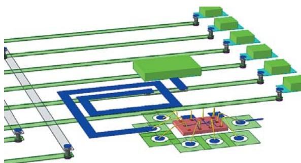
Рис. 13. Топология усилителя мощности с планарной катушкой индуктивности
