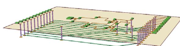
Рис. 16. Пример экранировки сигнальных проводников с помощью внутреннего слоя металлизации
