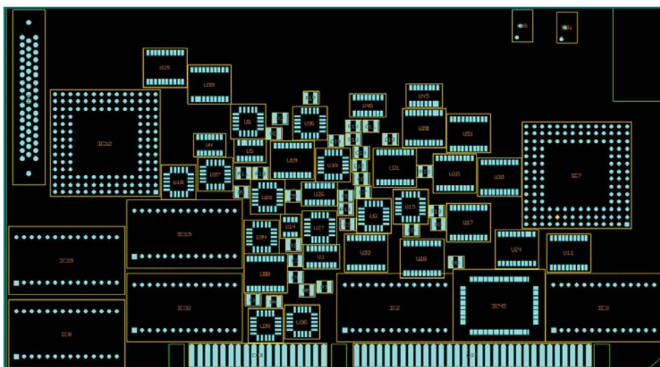
Рис. 10. Результат работы процедуры размещения Refine Placement
