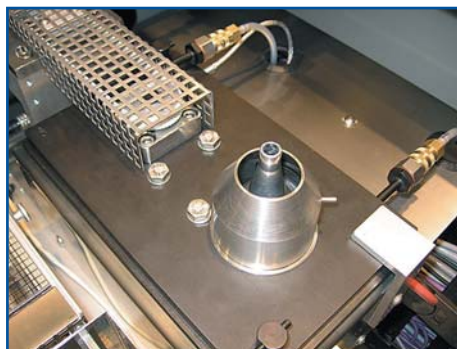
Рис. 5. Модуль, оснащенный соплом пайки миниволной
