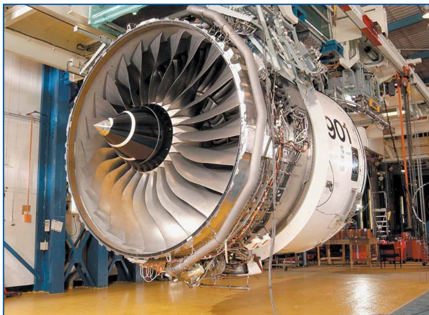
Рис. 1. Крупнейший в мире авиационный двигатель TRENT 900 для авиалайнеров Airbus A-380 (совместное производство Samsung Techwin и Rolls-Royce)
