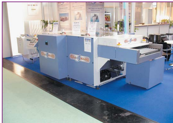
Рис. 5. Автоматическая установка снятия заусенцев/подготовки поверхности заготовок толщиной от 45 мкм
