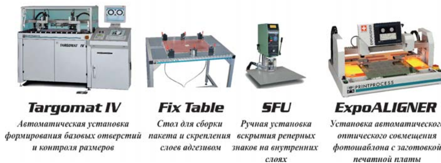
Рис. 6. Бюджетный комплект высокоточной системы совмещения для прототипного производства прецизионных МПП
