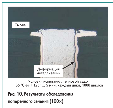
Рис. 11. Деформация межслойного отверстия при термоциклировании
