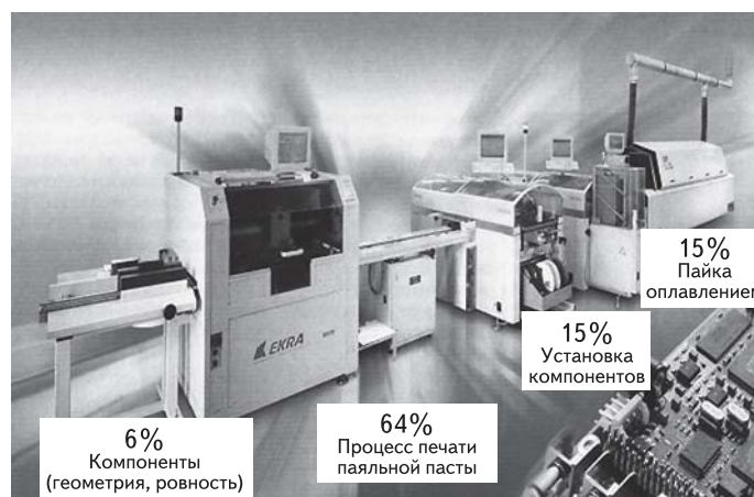
Рис. 5. Доля дефектов отдельных процессов в промышленном изготовлении электронных SMD-модулей (состояние на 2003 год)
