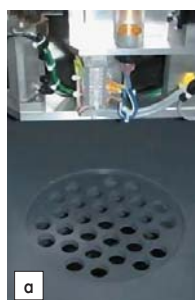
Рис. 4. а) Внешний вид вентиляционного канала; б) схематичное расположение каналов в станине станка
