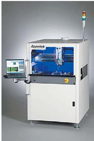
Рис. 1. Система селективного нанесения влагозащитных покрытий SL-940E
