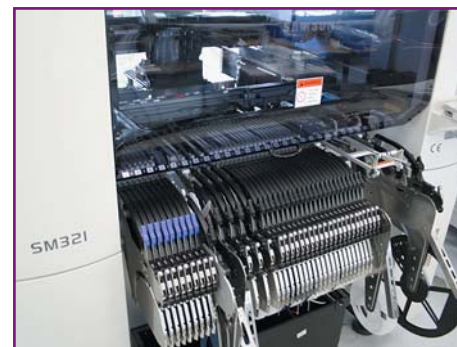
Рис. 2. База питателей автомата Samsung SM-321
