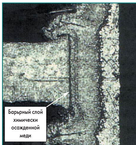
Рис. 3. Барьерный слой на стыке торца контактной площадки внутреннего слоя МПП и металлизации отверстия
