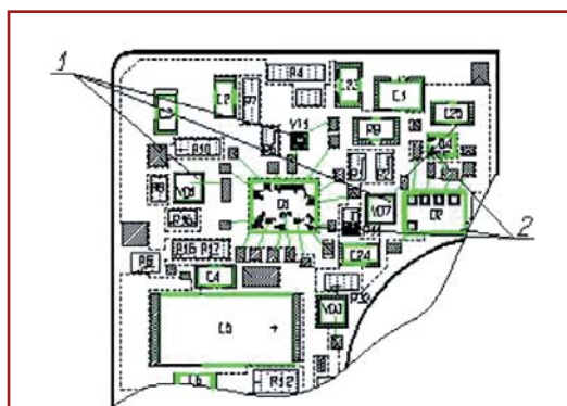
Рис. 1. Фрагмент платы для микро модуля питания: 1 — бескорпусные полупроводниковые кристаллы, устанавливаемые на припой; 2 — бескорпусные полупроводниковые кристаллы, устанавливаемые на клей
