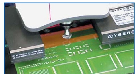
Рис. 9. Cyberoptics — лазерное центрирование компонентов «на лету»
