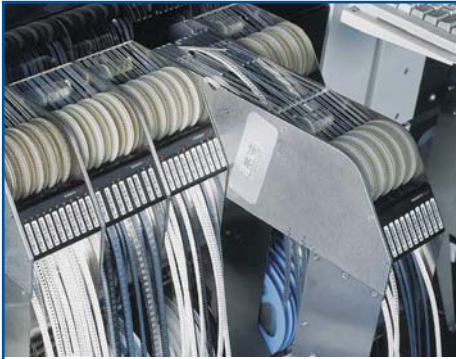
Рис. 2. Замена кассеты с питателями непосредственно во время работы автомата
