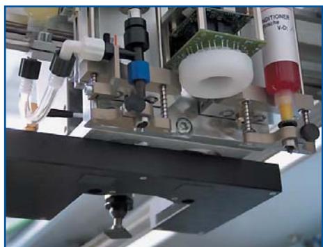
Рис. 11. Опциональный одинарный или двойной дозаторы увеличивают диапазон применения системы установки компонентов
