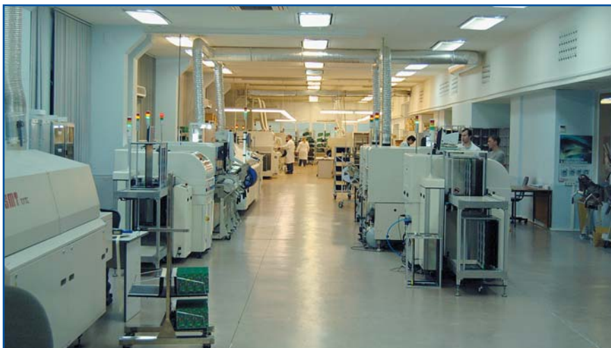
Рис. 1. Производственные линии JUKI на предприятии «Инкотекс»
