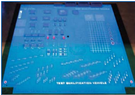
Рис. 12. Исследуемый образец нанесения ВП пульверизацией
