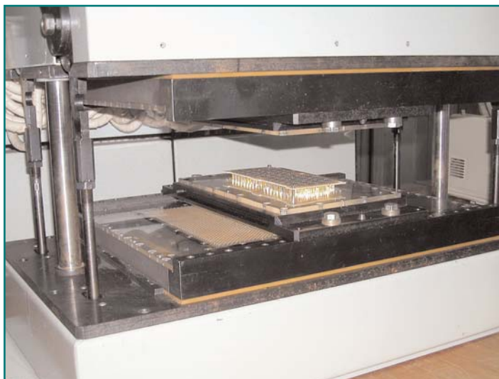
Рис. 4. Контактное устройство со сменными адаптерами под конкретные типы плат
