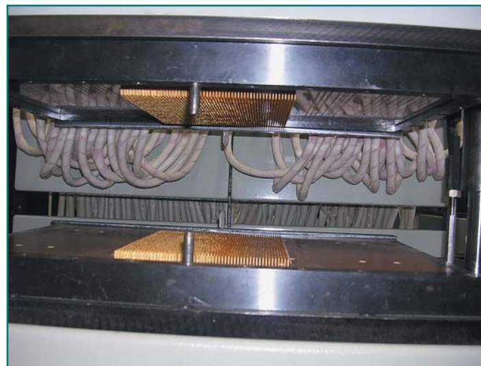
Рис. 6. Базовое контактное устройство
