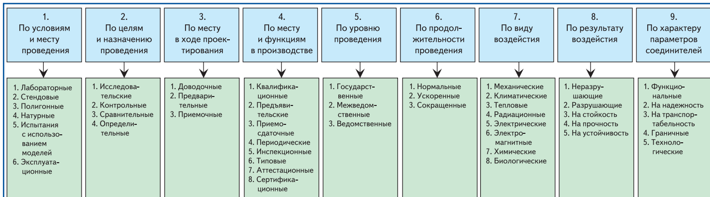
Рис. 2. Классификация видов, методов и технологии испытаний электрических соединителей
