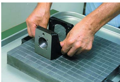
Рис. 2. Ручная шлифовка всех деталей перед установкой
