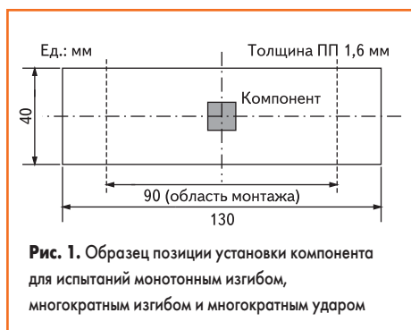
Рис. 1. Образец позиции установки компонента для испытаний монотонным изгибом, многократным изгибом и многократным ударом
