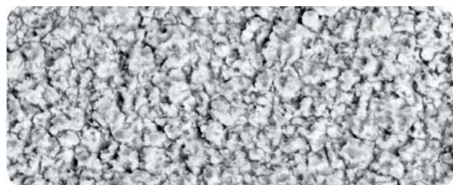
Рис. 4. После обработки TOP BOND: высокая адгезия развитой поверхности, включая боковые стенки. 2000-кратное увеличение
